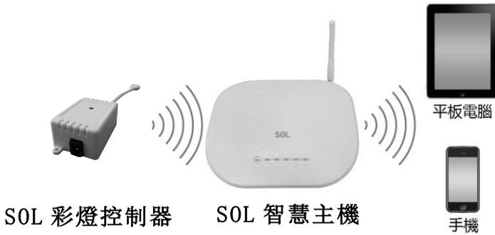
2. 接上電源後，【ZigBee 連線指示燈】將呈現慢速閃爍(2 秒 1 次閃爍循環)，即表示設備已進入等待連網狀態。(若無亮燈，請長按 set 設定鍵 10 秒回復原廠設置。)
