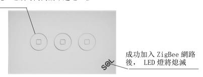
3. 按住【按鍵一】10 秒後,可恢復為原廠設置,【ZigBee 連線指示燈】閃爍 30 秒後燈熄滅。(恢復出廠設置預設為不加入ZigBee 網路)
